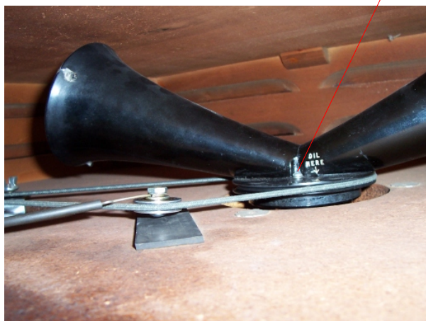
Orifice de lubrification des trompes (1 à 2 gouttes seulement)
